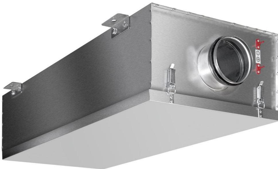
**Вентиляторные блоки CAUF VIM** состоят из секции фильтрации и вентиляторной секции, объединенных в компактном корпусе. Конструкция вентиляторного блока CAUF VIM предусматривает установку опционального электрического нагревателя EH/CAUF необходимой мощности.
