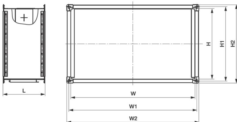
**Воздушные фильтры серии FBRr-K** предназначены для очистки от пыли наружного и рециркуляционного воздуха в системах приточной и вытяжной вентиляции.
