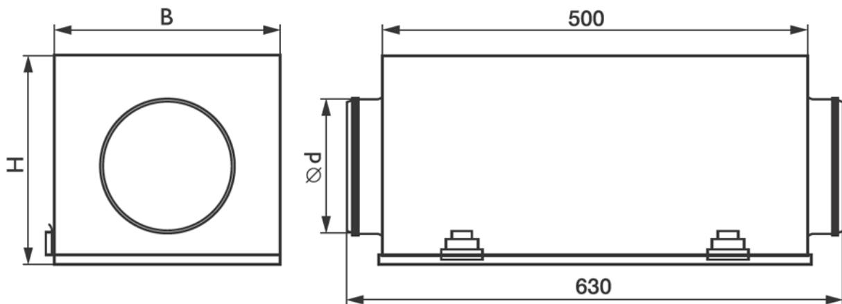
**Воздушные фильтры серии FBCr-P** предназначены для очистки от пыли наружного и рециркуляционного воздуха в системах приточной и вытяжной вентиляции. Применяются в системах вентиляции и кондиционирования круглого сечения.
