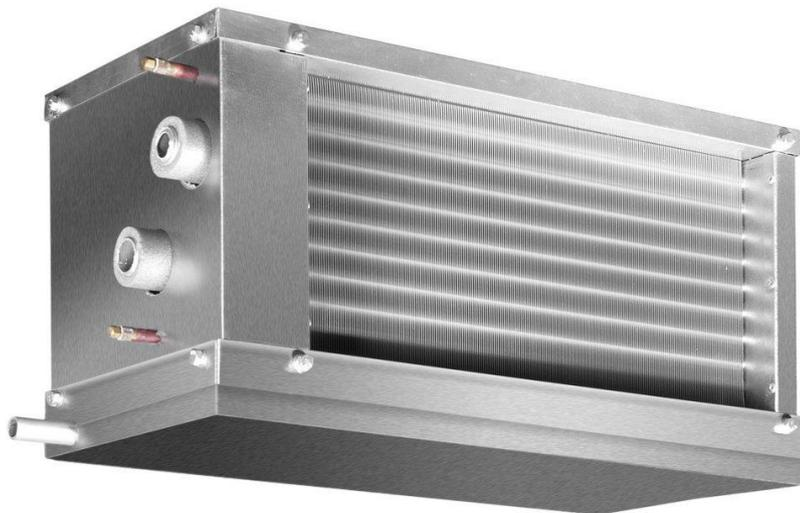
**Водяные воздухоохладители серии WHR-R** предназначены для охлаждения воздуха в канальных системах вентиляции и кондиционирования. Охладители устанавливаются непосредственно в канал. В качестве хладагентов в охладителях используются незамерзающие смеси и фреон. Корпус охладителей выполнен из оцинкованного стального листа.
