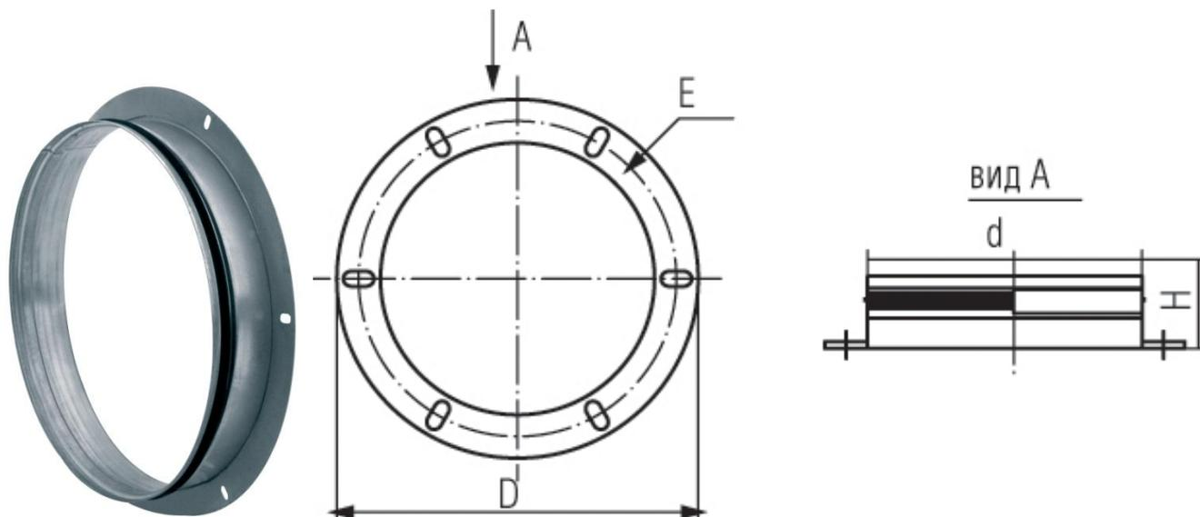
Фланцы FGV с резиновым уплотнителем предназначены для присоединения вентиляторов к воздуховодам. Изготовлены из оцинкованной стали.
