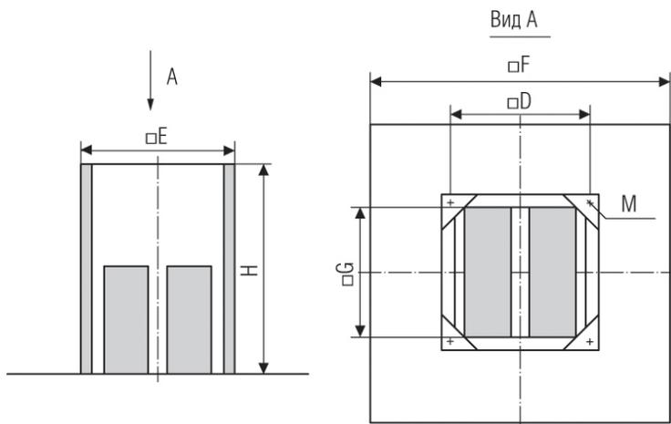
Крышные короба с шумоглушителями для монтажа на плоской кровле RCS выполнены из оцинкованной стали. Шумоглушающий материал обладает стойкостью к износу при скорости воздуха до 20 м/с.
